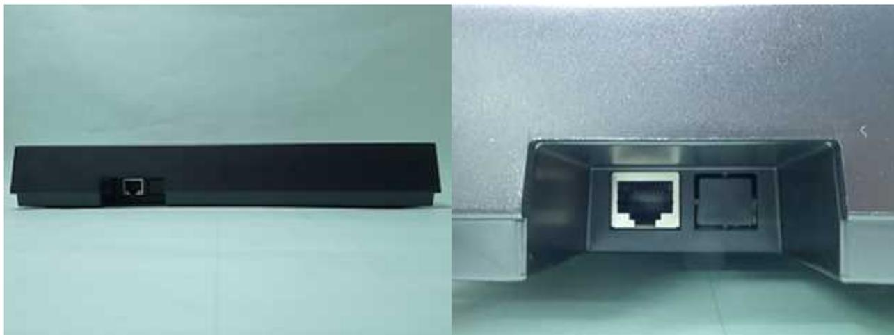
キーボード背面には専用 USB ケーブルを差し込むモジュラーjackがあります。モジュラーjackへ専用 USB ケーブルを接続して使用します。
